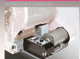
無段変速式印刷電動装置(オプション)
